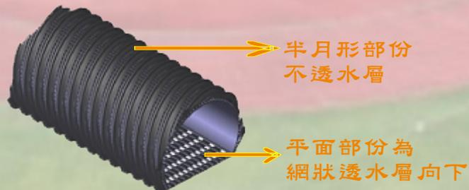
AMP-滲透網管利用水與土分離重力原理，不需不織布等濾材不易產生阻塞，生態工法施工，壽命長，解決地下排水管材阻塞問題的最佳透集排水資材。
