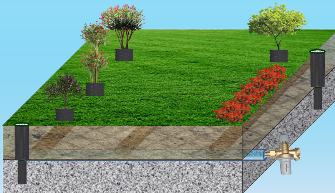
7. 植生完成屋頂灌溉排水綠化
