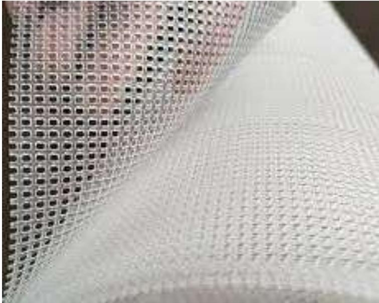
塑膠擠出方形網是運用模具上下運動連續擠壓工藝製造的，該工藝生產出具有整體接頭的方形塑料網材料。我們的原料和配方根據最終產品應用和客戶設定的性能要求而有所不同。從零件保護，過濾、基礎設施和建築產品，我們的擠方網提供卓越的保護、包容和分離能力。
